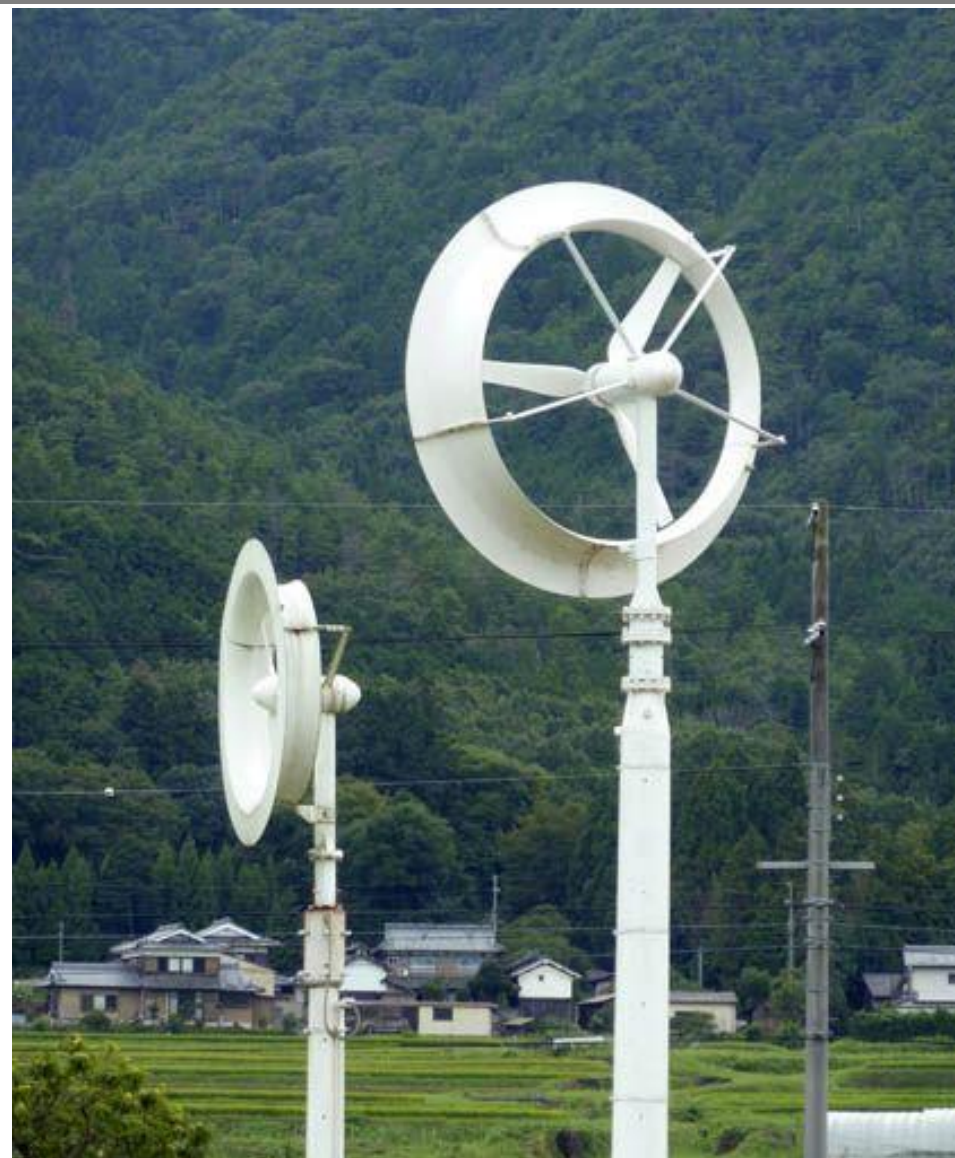
実用化されている集風装置をつけた風車
