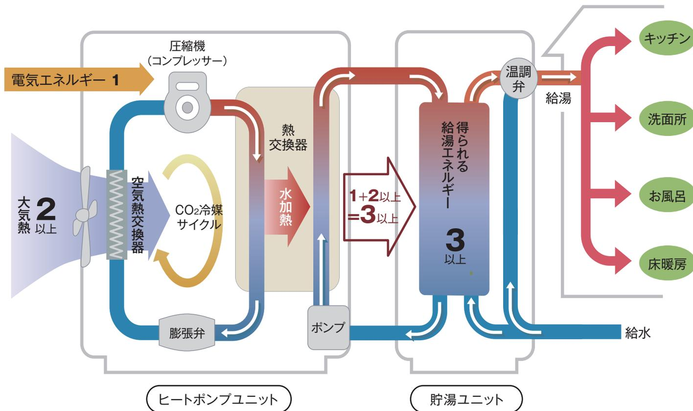
$$1 \text{ 電気エネルギー} + 2 \text{ 以上 大気熱} = 3 \text{ 以上 得られる給湯エネルギー}$$
