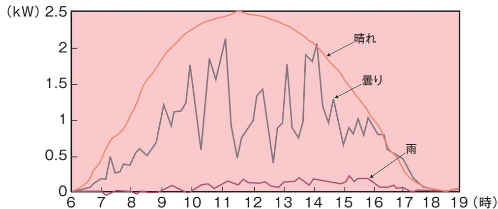
容量3.2kW、北緯34.4°、東経132.4°、方位角0°(真南)、傾斜角30°の場合
