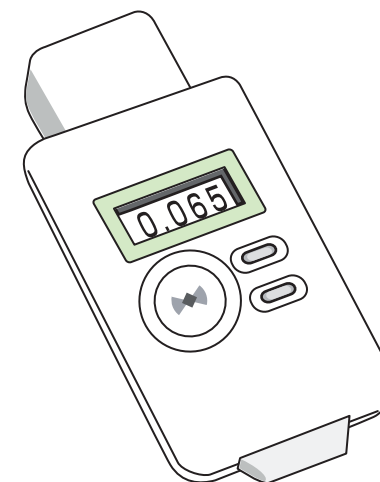
CsI シンチレーション式 (主に低線量の測定)
