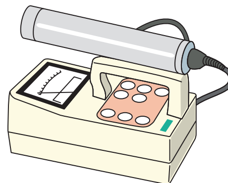
NaI シンチレーション式 (主に低線量の測定)
